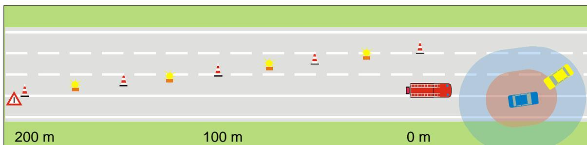
Abb.: Mindestanforderung an eine Verkehrsabsicherung bei schnell fließendem Verkehr
