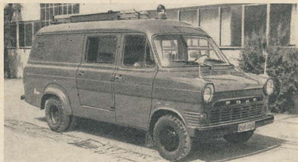
Abb. 1 Tragkraftspritzen-Fahrzeug TSF unter Verwendung eines Ford FT 1300 zur Beförderung einer Löschstaffel und der Ausrüstung für eine Löschgruppe. Lagerung der Leiter auf dem Dach.
