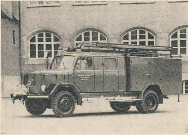
Abb. 6 Löschgruppenfahrzeug LF 16 - TS mit Vorbaupumpe und Allradantrieb, Fahrgestell Typ F Magirus 150 D 10 A, Radstand 4,20 m, 150-PS-Motor.
