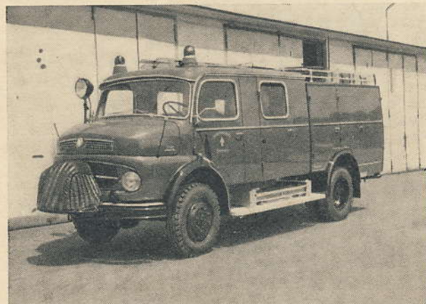
Abb. 4 Löschgruppen-Fahrzeug LF 8 - TS schwer mit Vorbaupumpe, Allradantrieb und Radstand 3,60 m, Fahrgestell DB 710/36.
