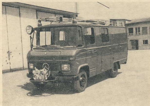
Abb. 3 Löschgruppen-Fahrzeug LF 8 - TS mit Vorbaupumpe bei Verwendung eines Fahrgestells DB 408 G.
