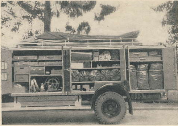
Abb. 11 Gerätewagen, Ansicht der Geräteräume auf der linken Fahrzeugseite: Werkzeug, Greifzeug, Hebezeug, Ölwehrrgeräte; auf dem Dach: Schlauchboot mit Eisschlitten; auf dem Trittbrett: Kanthölzer.
