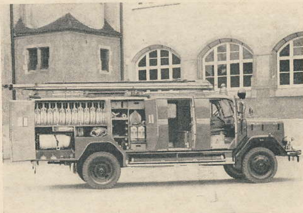
Abb. 7 LF 16 - TS. Ansicht der Geräteräume auf der rechten Fahrzeugseite: Schaumausrüstung, Beleuchtungsgerät, Strahlrohre, Sprungtuch und Druckschläuche.
