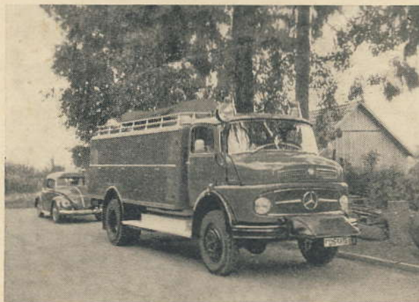
Abb. 10 Gerätewagen mit Vorbauseilwinde und Allradantrieb, Fahrgestell DB 1113, Radstand 4,20 m, 150-PS-Motor, Truppbesatzung.
