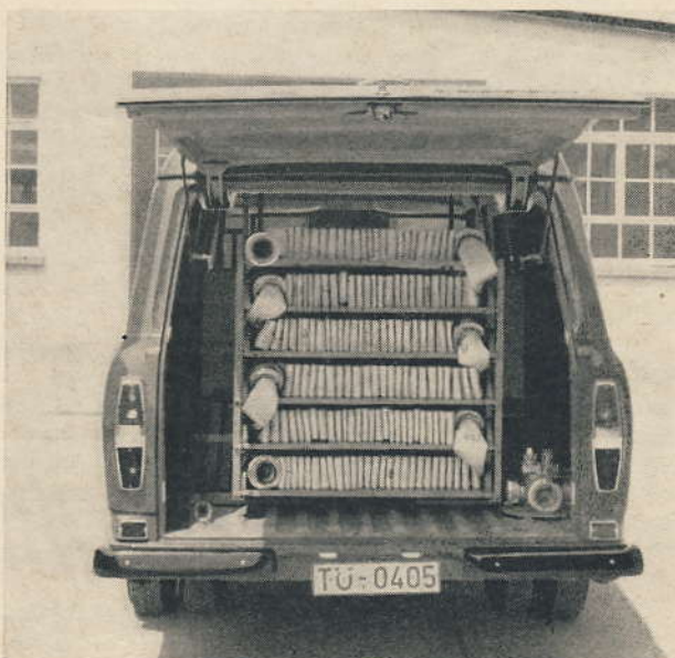
Abb. 12 Schlauchwagen zum Transport von ca. 900 m B-Schläuchen, davon ca. 600 m in Buchten gelagert, Fahrgestell Ford FT 1300.
