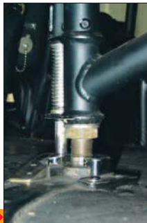
4) Der komplette Sitz kann nach hinten weggeschwenkt werden.
