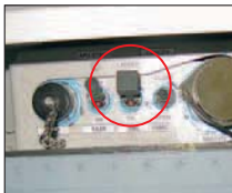
1) Schalter mit dem Viereckkopf.
