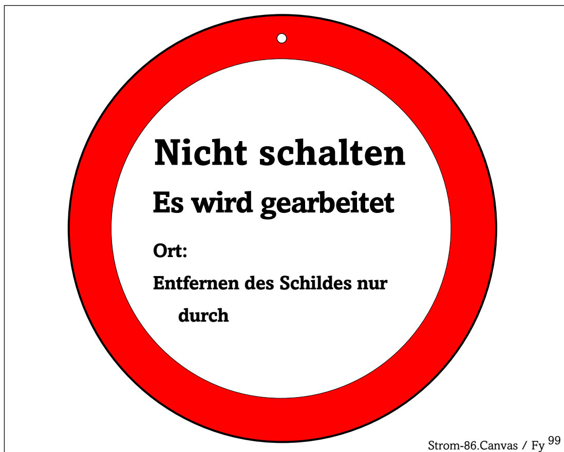
Bild 7: Verbotsschild mit der Sachaussage » Nicht schalten « und der zusätzlichen Aussage » Es wird gearbeitet / Ort / Entfernen des Schildes nur durch... «
