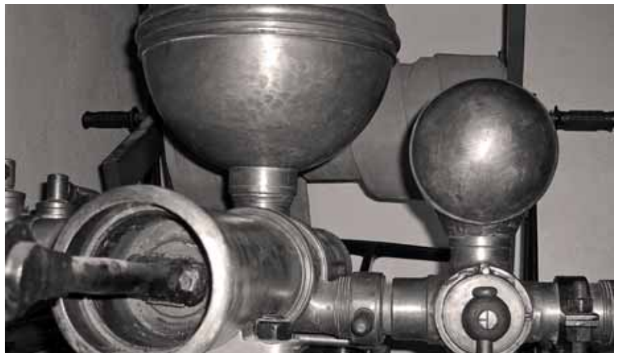
Voll funktionsfähig ist die Patent-Saugfeuerspritze aus dem Jahr 1863. Die neue Technik mit Windkessel und Vorwindkessel ermöglichte eine kontinuierliche Wasserabgabe.
