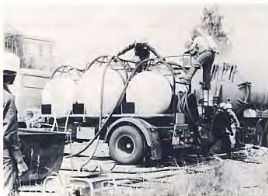
Die Ladung (Salpetersäure) wird in Spezialtanks umgefüllt.
